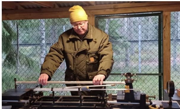
Normaaliperusviivan mittaaminen on osaamisen ja sääolojen puolesta vaativa projekti. Mittaus tehdään Väisälän interferenssikomparaattorilla, joka mittaa pituutta peilien välillä heijastuvien valonsäteiden avulla. Kuva: Maanmittauslaitos
