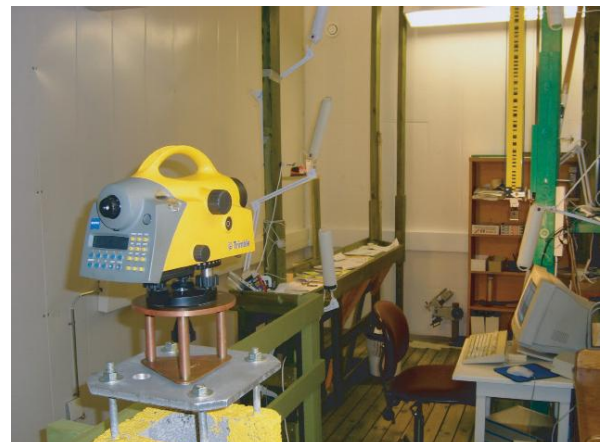
Kuva 4. Digitaalisen tarkkavaaituskojeen ja viiva-koodi-latan järjestelmäkallointia.
