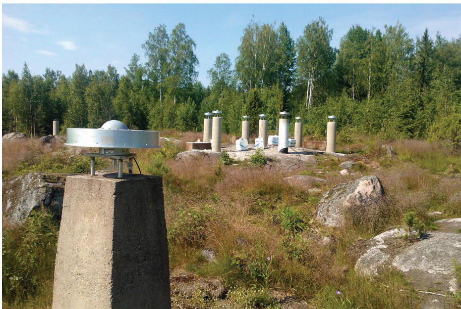
Kuva 5. GNSS-antennien tarkkuustutkimusta voidaan tehdä Metsähovin observatorion testi-kentällä.
