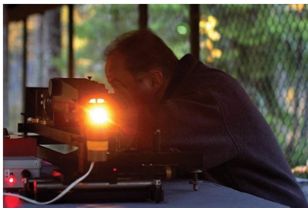
Kuva 1 ja 2. Väisälä-komparaattorilla mitattu Nummelan normaaliperusviiva on ollut yksi maailman tarkimmista ja vaikeimmista pituuksista jo yli puolen vuosisadan ajan.
