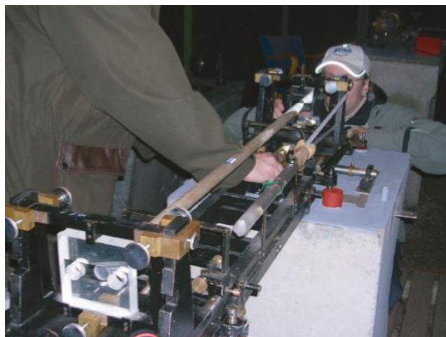
Kuva 1 ja 2. Väisälä-komparaattorilla mitattu Nummelan normaaliperusviiva on ollut yksi maailman tarkimmista ja vaikeimmista pituuksista jo yli puolen vuosisadan ajan.
