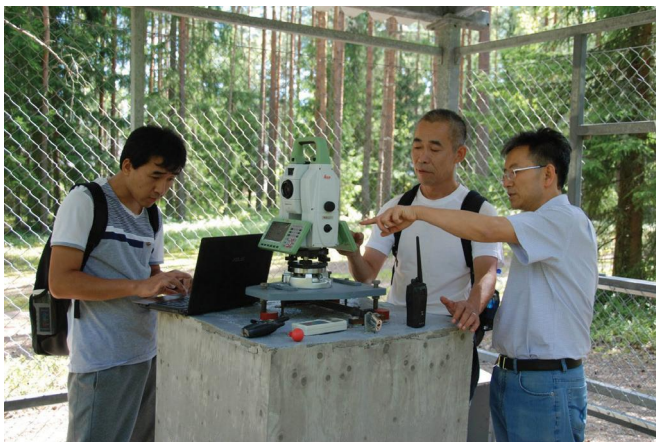
Kuva 3. Maailman tarkimpien etäisyysmittareiden kalibrointia tehdään Nummelan normaaliperusviivalla. Nummelan mitta-kaava on myös siirretty lukuisille ulkomaisille perusviivoille.
