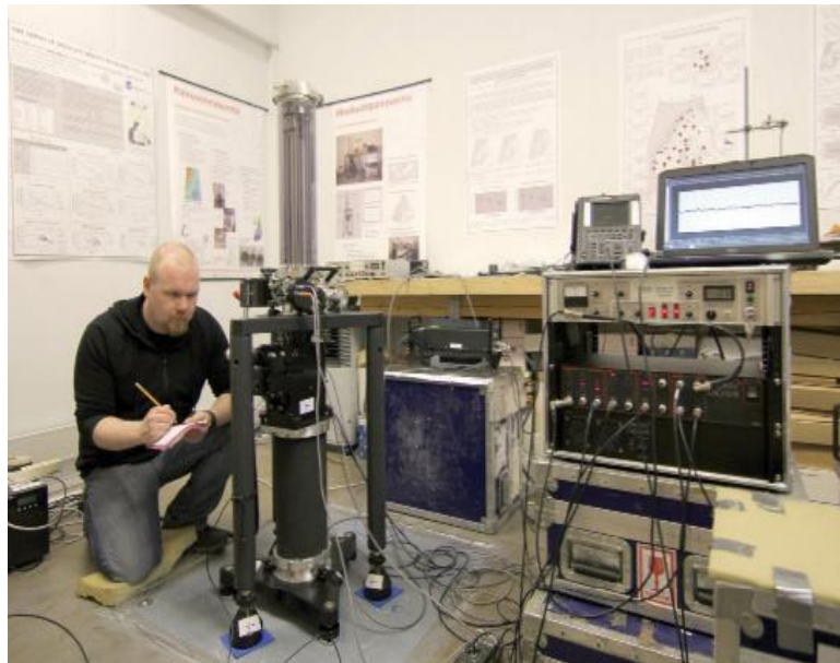
Kuva 3. Absoluuttigravimetri FG5X-221 perustuu pudotuskokeeseen tyhjöissä.
