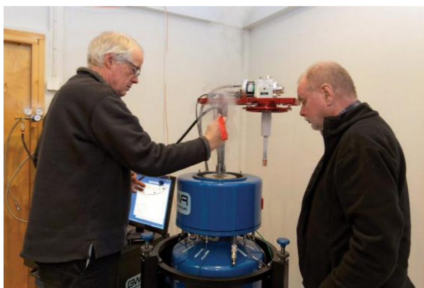
Kuva 4. Suprajohtava gravimetri (Metsähovi, Kirkkonummi) rekisteröi jopa 0,1 \text{ nm s}^{-2} vaihtelut putoamiskiihtyvyydessä.
