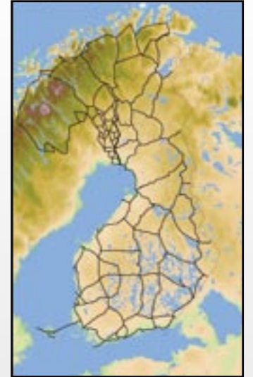
Karta 3: Linjenätet för den tredje rikstäckande precisionsavvägningen samt delar av det avvägningsnät som använts i Sverige och Norge för att skapa det nya höjdsystemet.
