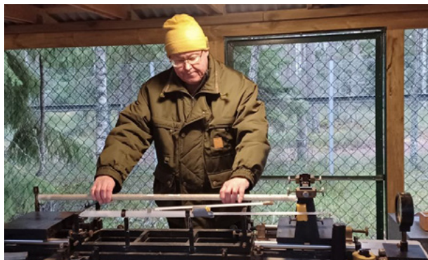
Mätning av normalbaslinjen är ett krävande projekt med avseende på kompetens och väderförhållanden. Mätningen görs med en Väisälä interferenskomparator, som mäter längd med hjälp av ljusstrålar som reflekteras mellan speglar. Bild: Lantmäteriverket
